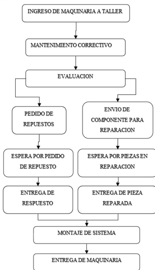
Figura N° 26. Flujograma de Mantenimiento Correctivo desarrollado.
