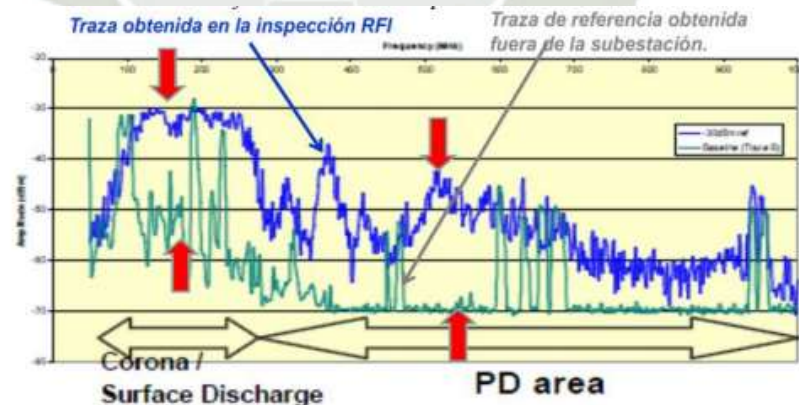
Figura 13 Comparación de trazas de Radiofrecuencia en una inspección RFI
