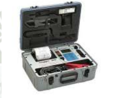
Figura 33 Medidor de impedancia de baterías BITE 2
