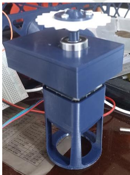
Figura 55: Motor paso a paso con caja reductora y catalina de traccion instalados
