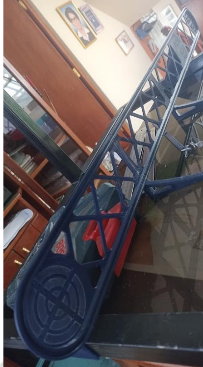
Figura 52: Lateral de la faja transportadora ensamblado
