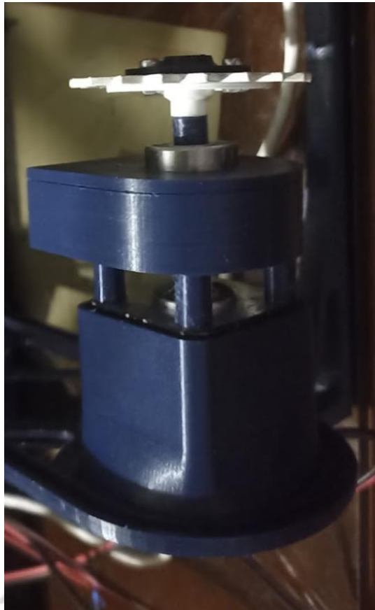
Figura 56: Reductor instalado en la faja
