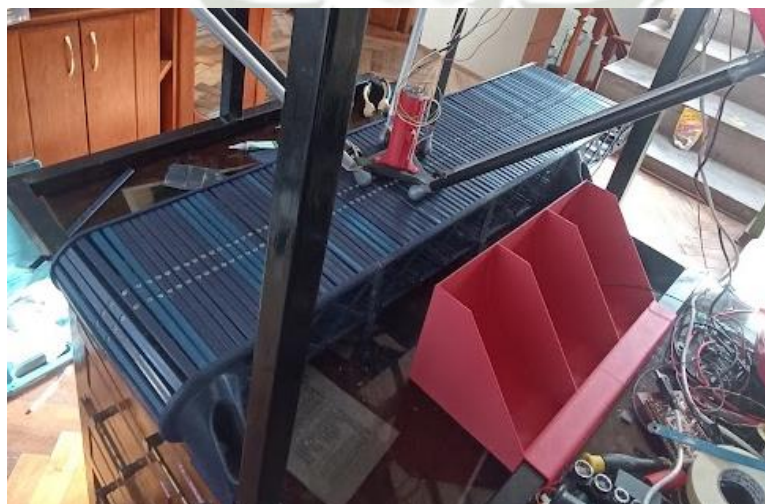
Figura 54: Faja transportadora ensamblada en su totalidad
