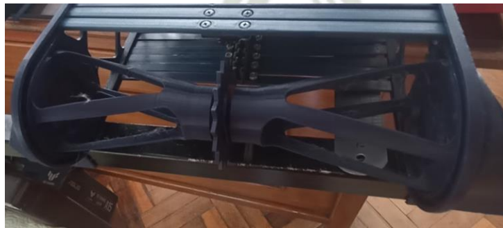
Figura 50: Sistema de retorno de la faja transportadora
