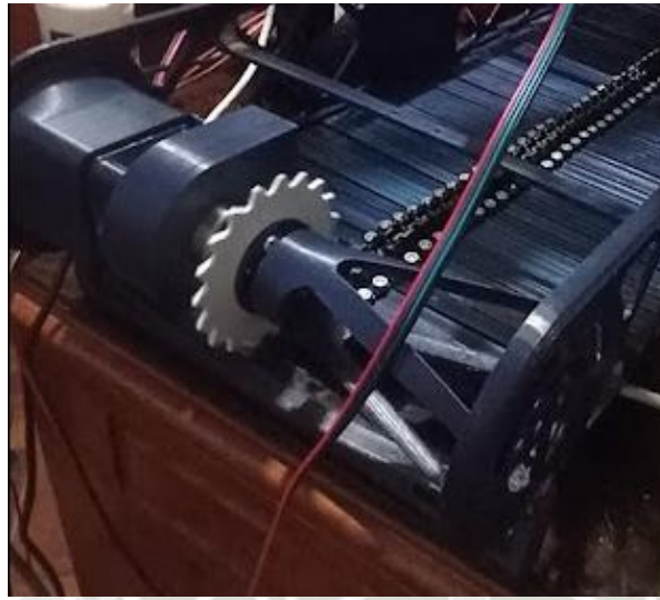
Figura 49: Sistema de tracción de la faja transportadora
