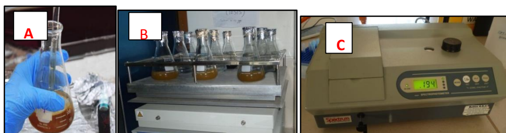
Figura 6: Proceso para la construcción cinética de crecimiento.
