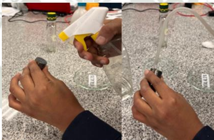
Figura 45 Limpiando la superficie de la probeta con alcohol y agua
