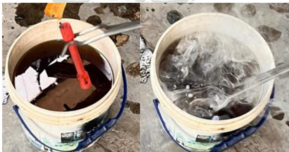
Figura 32 Se enfrían las piezas previamente calentadas en aceite agitado
