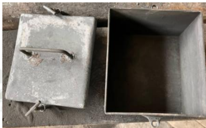
Figura 18 Caja cementante a utilizar en el proceso. Los parámetros longitudinales son: 15 cm x 15 cm x 10 cm
