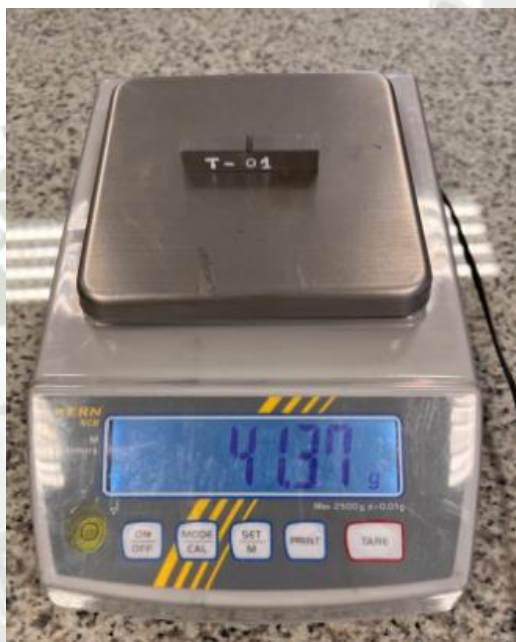
Figura 27 Pesado de la probeta de impacto
