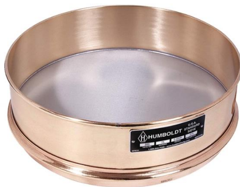
Figura 13 Tamiz ASTM E-11 número 6
