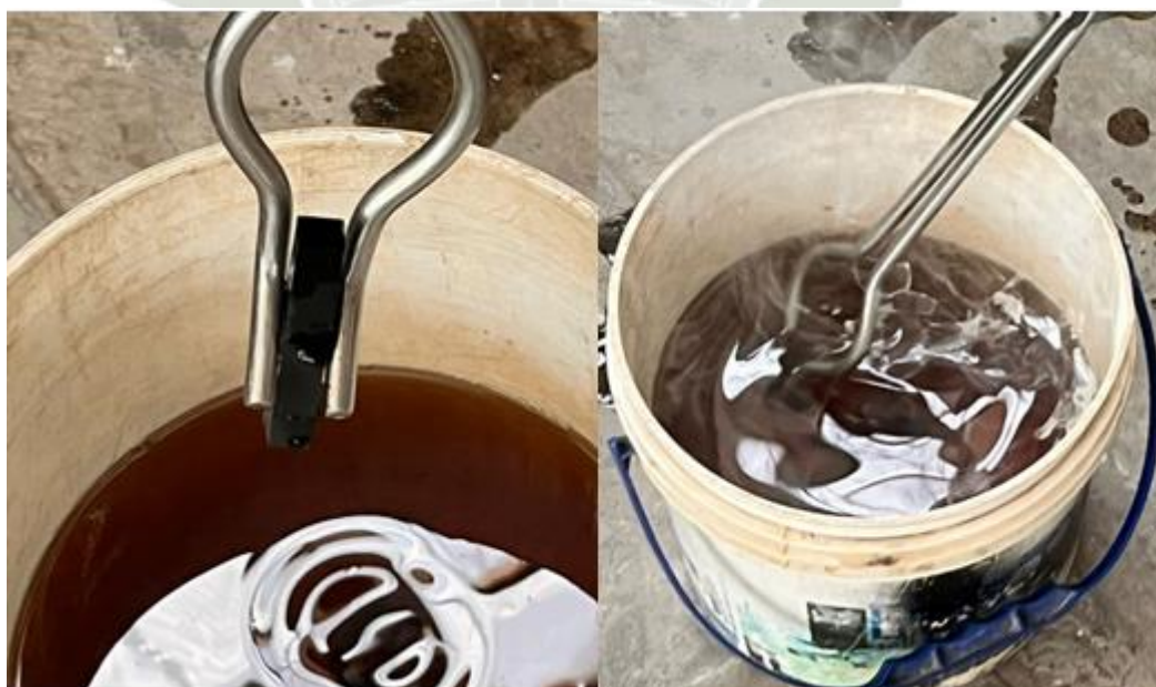
Figura 34 Enfriamiento de las piezas con dos temples
