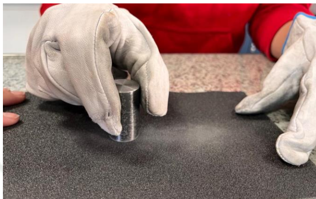
Figura 37 Pulido manual de la probeta con lija 60
