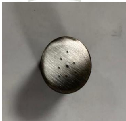
Figura 23 Huellas de indentador en la muestra patrón
