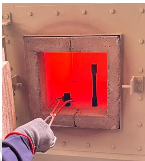
Figura 29 Colocación de las piezas al horno para realizar el primer temple
