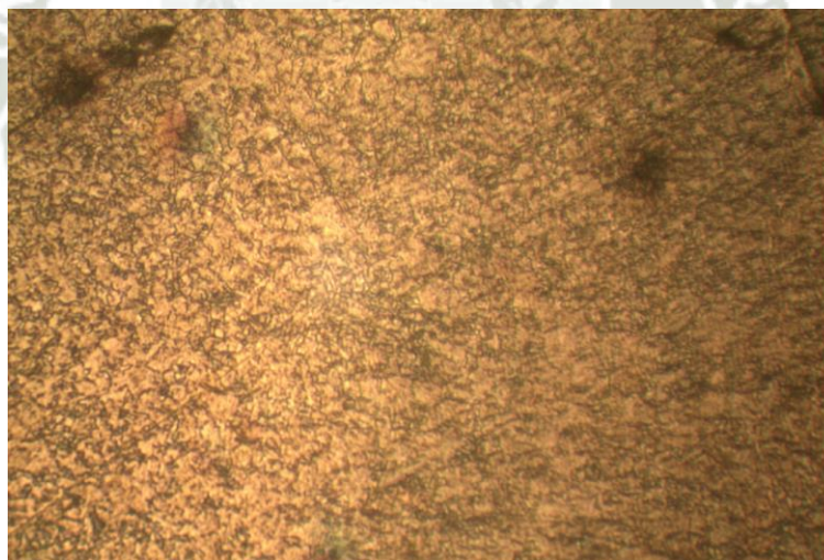
Figura 54 Micrografía de la probeta cementada + 2 temple + revenido (D-05)
