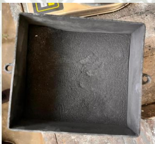
Figura 14 Carbón molido pasado por la malla N° 6
