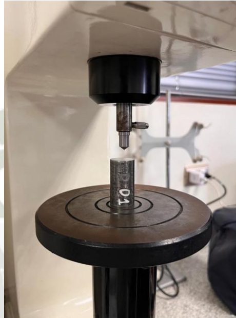
Figura 22 Probeta centrada para realizar el ensayo
