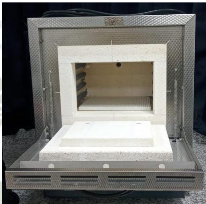
Figura 16 Horno mufla de la Universidad Católica Santa María
