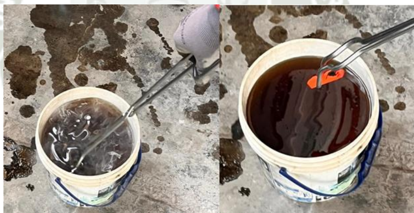
Figura 30 Enfriamiento de las piezas en aceite agitado
