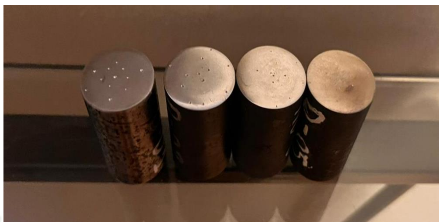
Figura 24 Probetas con las huellas del ensayo de dureza Rockwell C
