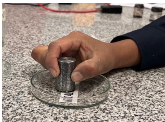
Figura 44 Atacado químico de la probeta con Nital al 3%
