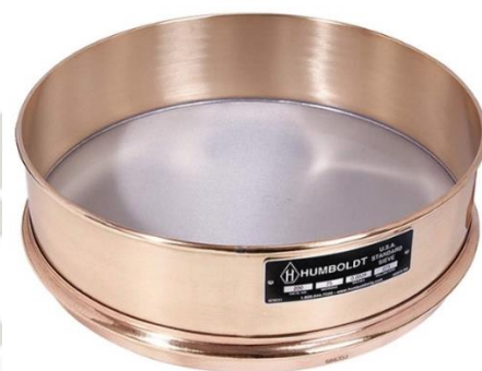
Figura 11 Tamiz ASTM E-11 número 4
