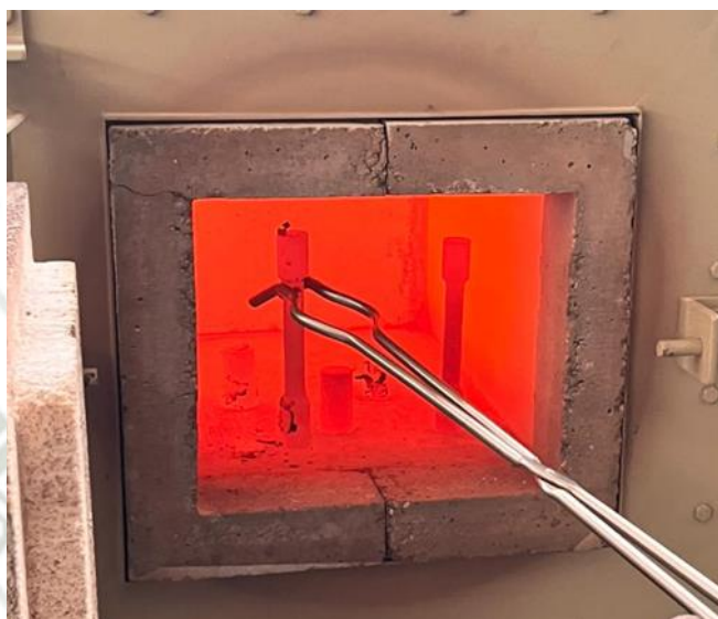
Figura 33 Colocación de las piezas con un temple dentro del horno
