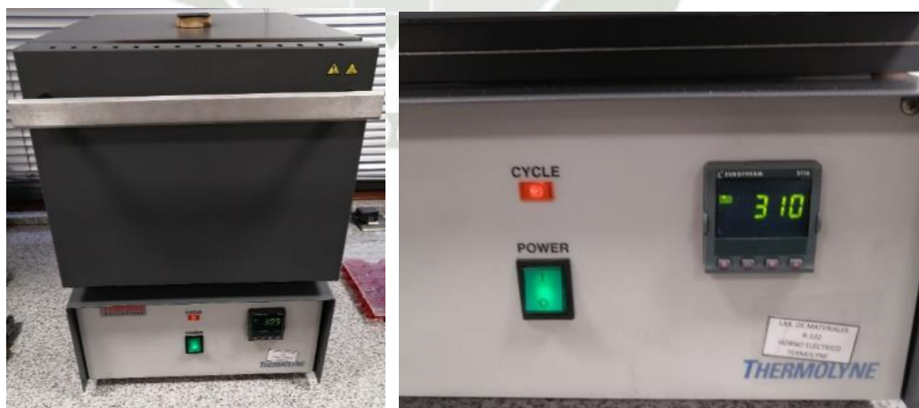
Figura 45 - Horno para calentamiento de Probetas a Temperatura óptima
