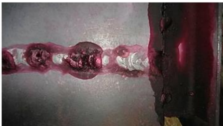
Figura 30 - Aplicación de LP a un cordón de soldadura
