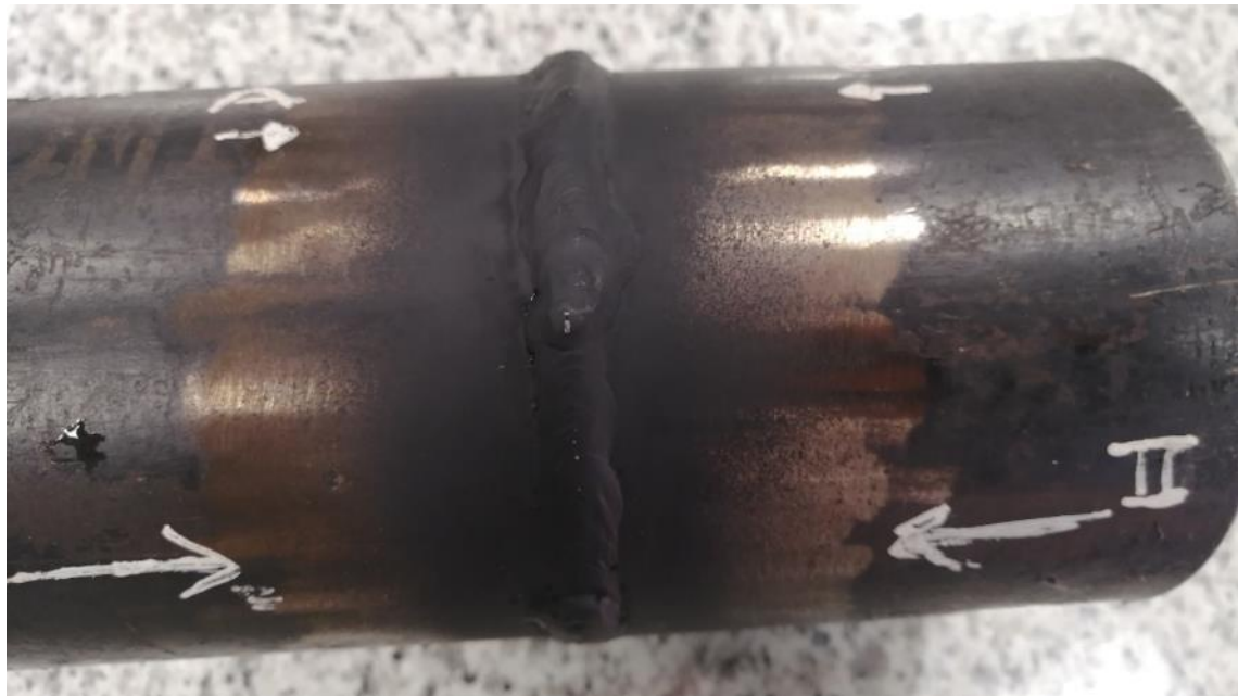
Figura 71 Probeta P4, Tubo de estudio, 3 vista Nota: Probeta "P4", zona estudio limpia y pintada con negro mate, tercera vista.
