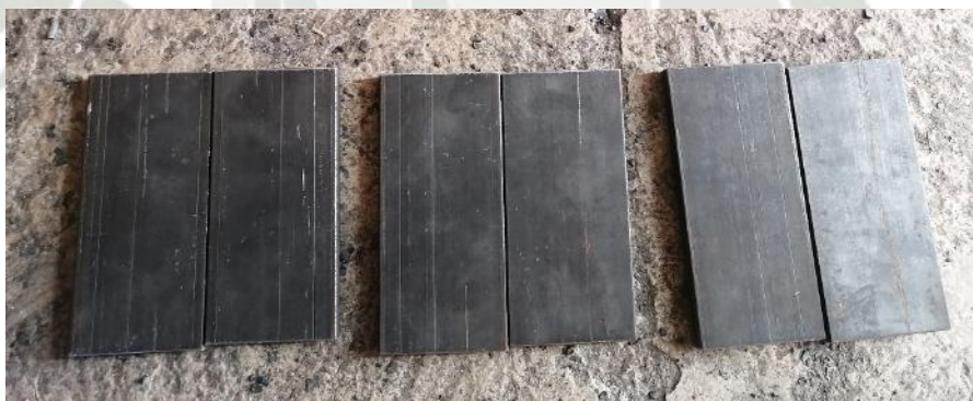
Figura 60 Platinas de Acero A36 preparadas Nota: Material utilizado para realizar las probetas "P1", "P2" y "P3"
