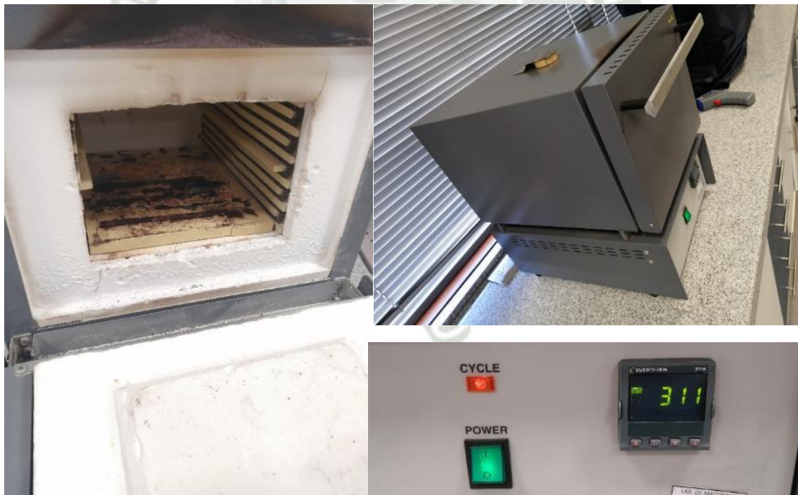
Figura 72 Horno para Realizar los ensayos Nota: Horno Thermolyne para llevar las probetas a la temperatura adecuada
