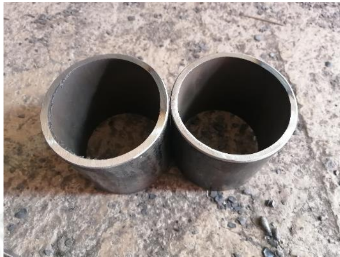
Figura 61 Tubo de Acero A53 Grado B Cedula 40 preparados Nota: Material utilizado para realizar las probetas "P4"
