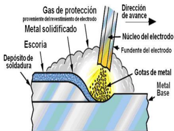
Figura 19 - Representación de soldadura SMAW
