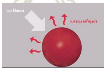
Figura N° 5. Un objeto con superficie roja absorbe todos los colores del espectro a excepción del rojo, el cual es reflejado de vuelta
