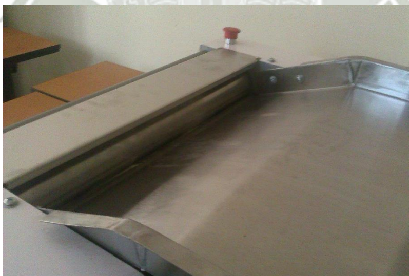
Foto N° 4: FOTOS DE LA MAQUINARIA LAMINADORA MASA DE PIZZA - VISTA DE LOS RODILLOS CON LA PLACA DE SEGURIDAD
