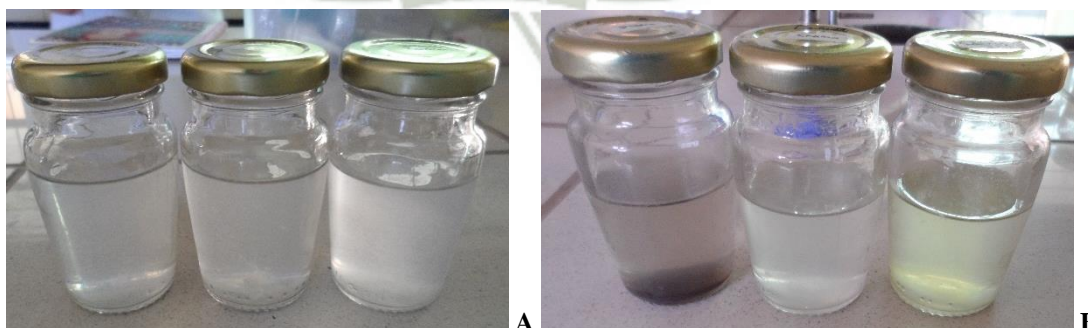
Figura 27. Bioprecipitación de plomo, cromo y cadmio. A. Medios de cultivo al inicio de la experiencia; B. Medios de cultivo al final de la experiencia, presencia de precipitados en la base del frasco.
