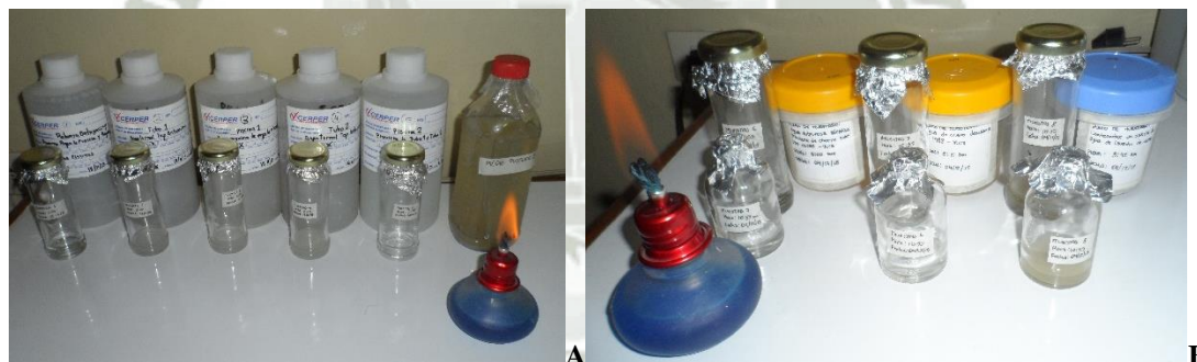
Figura 6. Siembra de bacterias reductoras de sulfato en medio líquido Postgate B. A. Muestras ambientales procedentes de Espinar – Cusco; B. Muestras ambientales procedentes de Arequipa.
