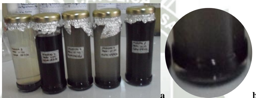
Figura 10. a) Crecimiento de bacterias reductoras de sulfato en medio líquido. b) Precipitado de Sulfuro de Hierro.
