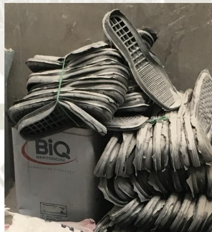
Figura 22: Suelas defectuosas de caucho negro.
