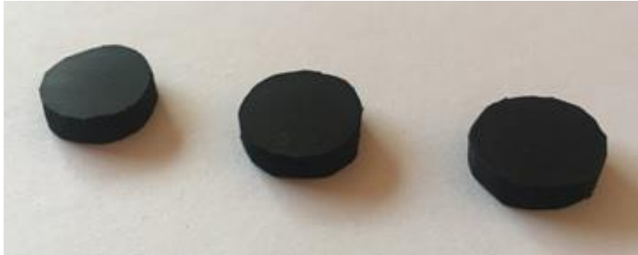
Figura 39: Probetas previo a la aplicación de la prueba de resistencia a la abrasión
