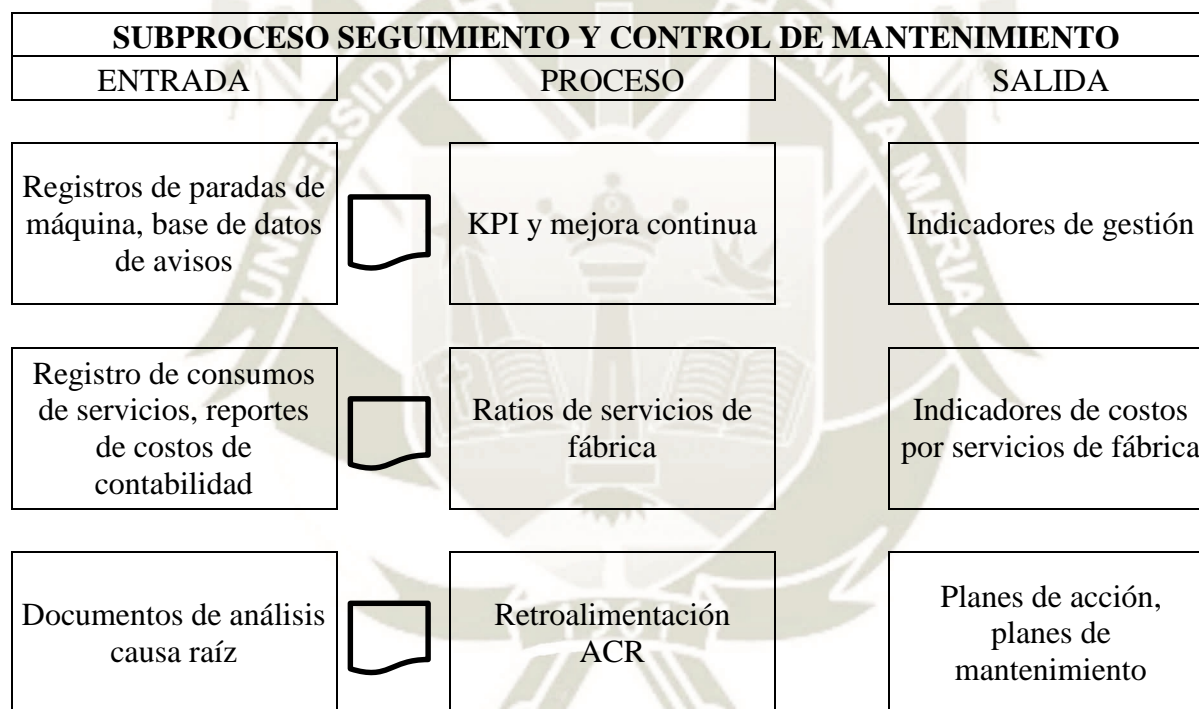
Figura 27 Proceso seguimiento y control de mantenimiento
