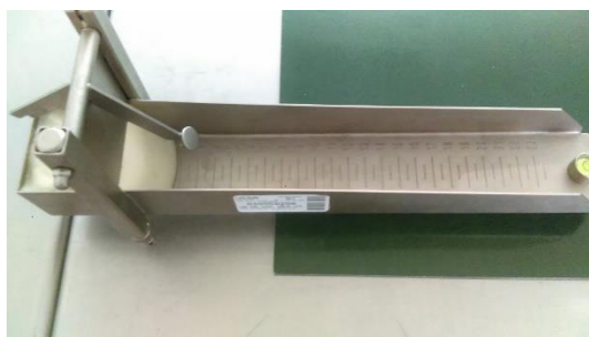
Ilustración 1: CONSISTOMETRO DE BOSTWICK
