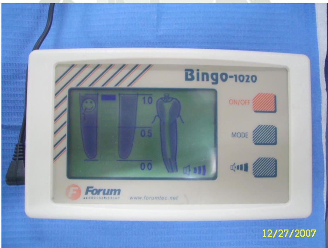
Registro de medida A 1 mm de ápice con el localizador apical bingo 1020 Forum technologies
