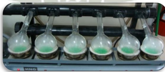
Figura 36. Digestión de las muestras
