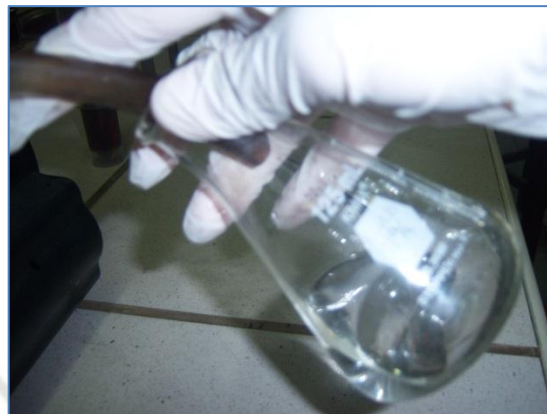
Figura 2.5 Evaporación de solvente con aire comprimido
