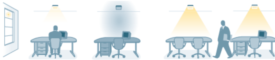
Figura 11: La luz se controla en función de la luz natural incidente y del movimiento.
