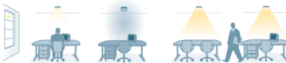
Figura 6: La luz se controla en función de la luz natural incidente y del movimiento.
