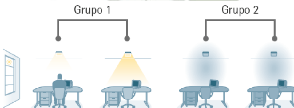
Figura 7: Las luminarias están agrupadas. En cuanto una luminaria detecta cualquier movimiento dentro del grupo, todo el grupo de luminarias permanece activo.
