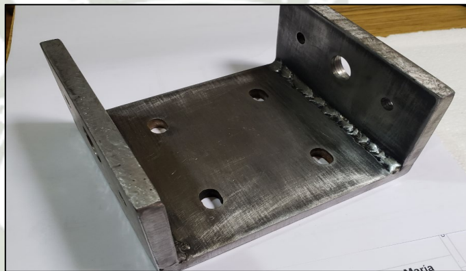
Figura 4.16 Fabricación de base fija
