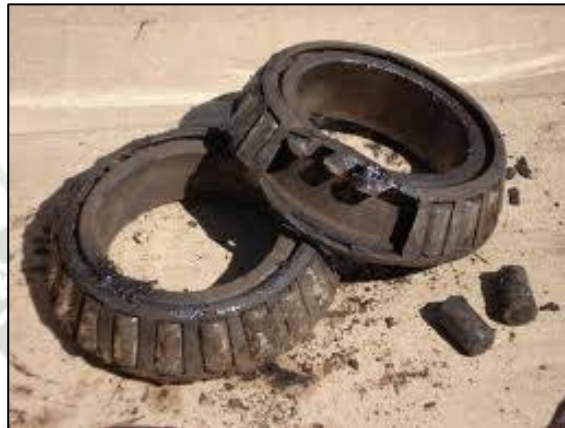
Figura 2.4 Corrosión por desgaste
