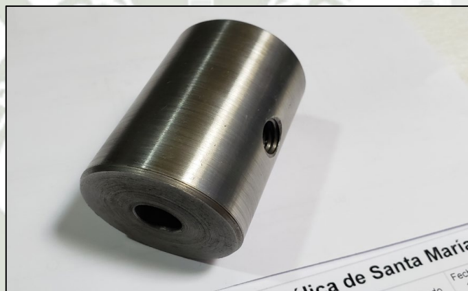
Figura 4.14 Fabricación del contrapeso
