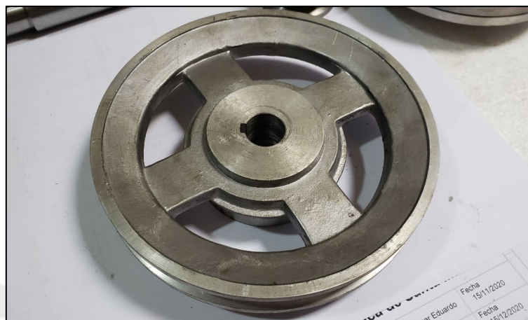
Figura 4.5 Fabricación de la polea conducida
