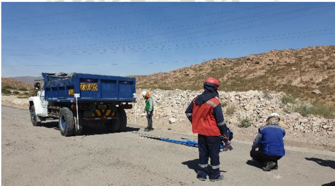
Ilustración 22 – Pruebas de deflectometría en base
