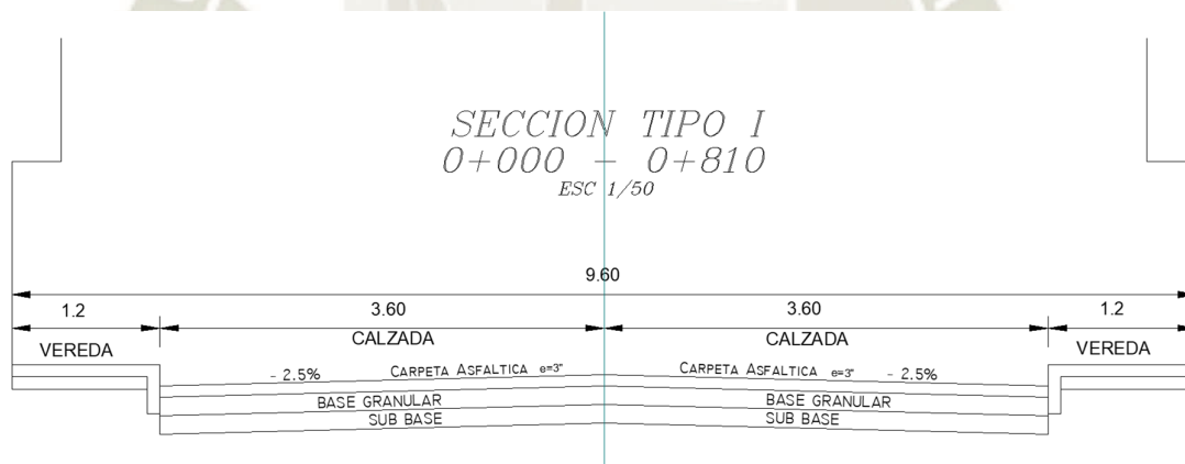
Ilustración 5 – Sección Tipo I Progresiva 0 + 000 – 0 + 810
