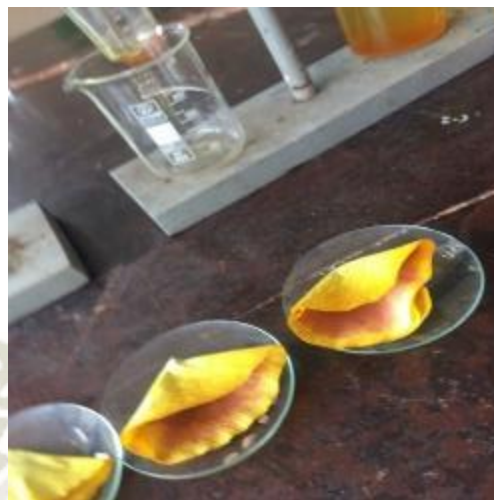
Foto 6: Filtrado de oro recuperado de ACD, para dispersar en agua.
