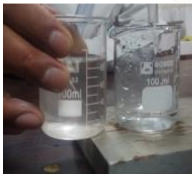
Foto 3: decantación y recuperación de oro.
