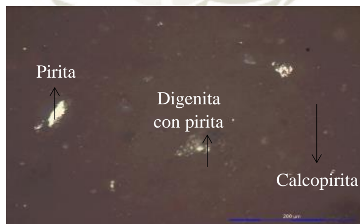
Figura 38 Pirita, calcopirita, y digenita con pirita a 200 \mu\text{m} .
