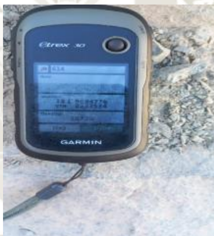
Figura 19 Ubicación del muestreo de relaves auríferos- cuenca baja (mediante Garmin mostrando las coordenadas UTM).
