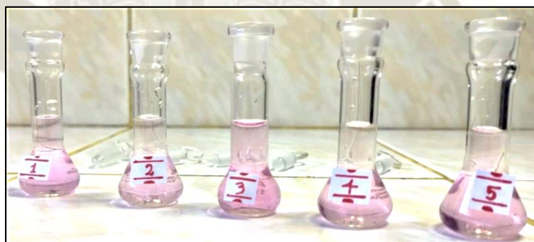
Figura 2.3. Soluciones de calibración para la determinación de la capacidad antioxidante por el método de DPPH
