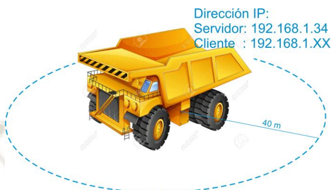
Figura 38. Área de cobertura de red Wifi para camión de acarreo.
