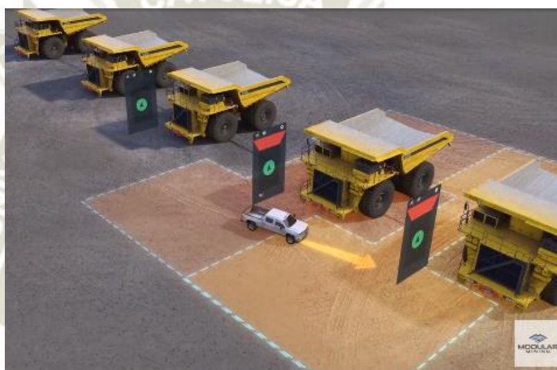
Figura 30. Sistema Mine Alert - detección de vehículos.
