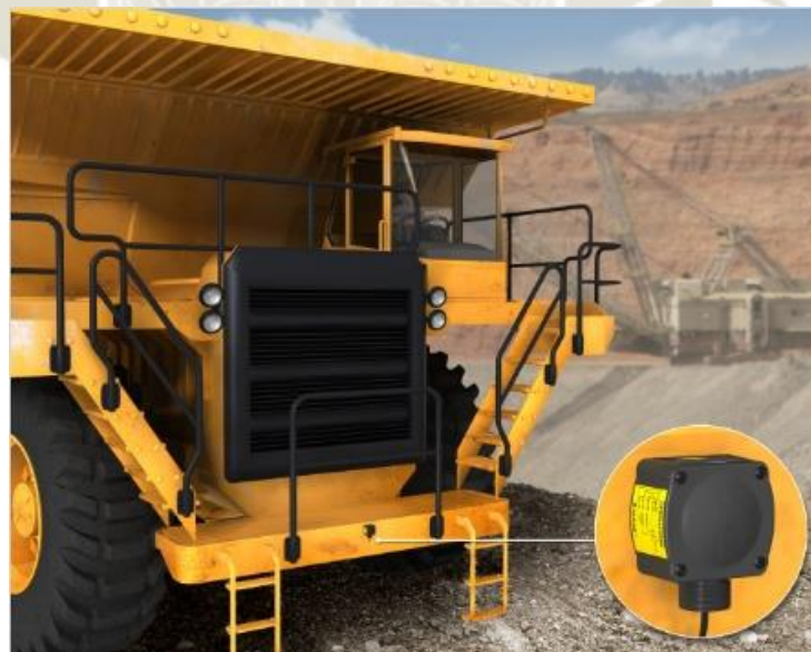
Figura 27. Disposición del radar de detección en equipo pesado.
