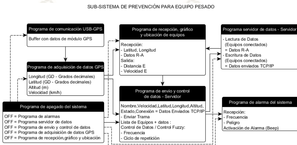
Figura 118. Diagrama de bloques - subsistema para equipos pesados.
