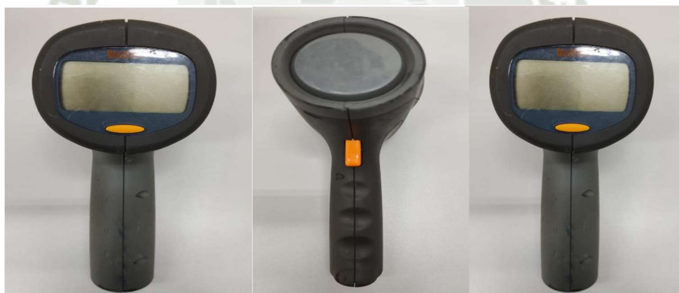
Figura 12 Pistola de velocidad Bushnell Speed Velocity Gun
