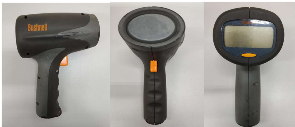
Figura 10 Pistola de velocidad Bushnell Velocity Speed Gun
