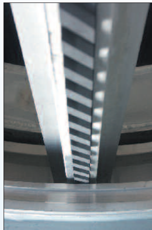
Rotor de cuchillas con elementos radialmente móviles en PTFE o grafito
