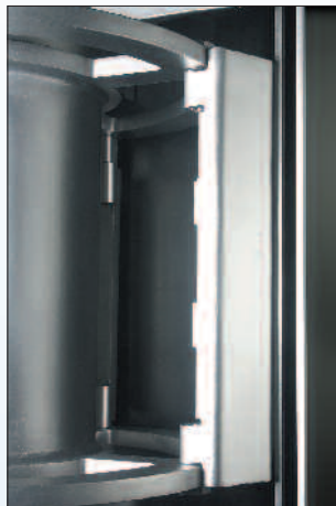
Rotor con cuchillas pendulares metálicas
