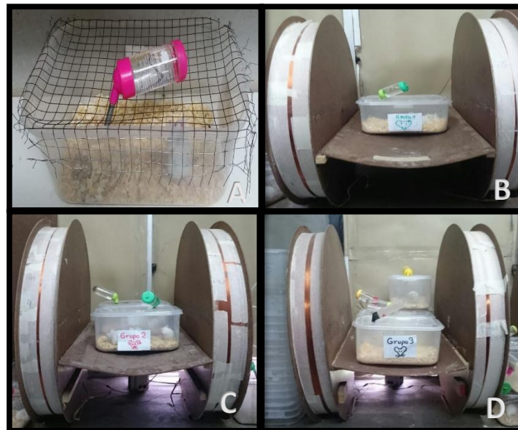
Figura 10. Exposición de los grupos de estudio: A. Grupo control, B. Grupo con exposición simulada, C. Grupo con exposición a campo magnético de 50 \mu\text{T} y D. Grupo con exposición a campo magnético de 550 \mu\text{T} .
