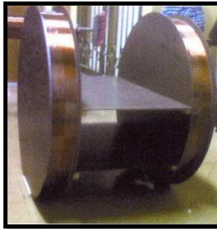
Figura 9. Sistema generador de campos magnéticos basados en bobinas de Helmholtz (111).
