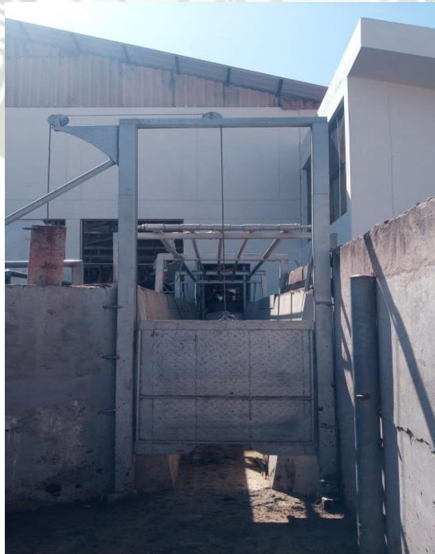
Foto N° 02. Cajón de sujeción de bovino para aturdimiento del camal de Kayra.
