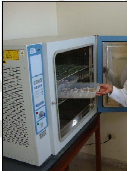
Foto N° 10: Colocación en la estufa de aire forzado a una temperatura de 55 °C por 48 horas.
