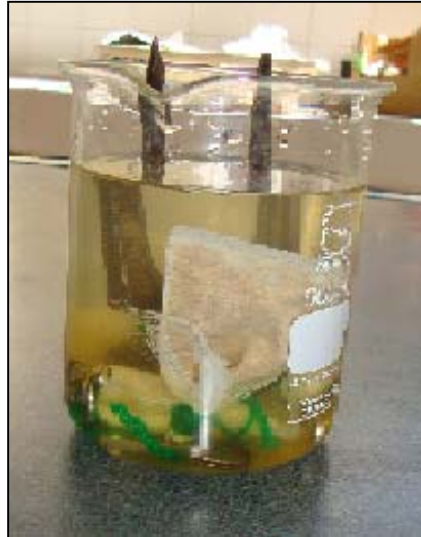
Foto N° 9: Tiempo 0 las bolsas se colocaron en agua tibia a 37 °C por 30 minutos
