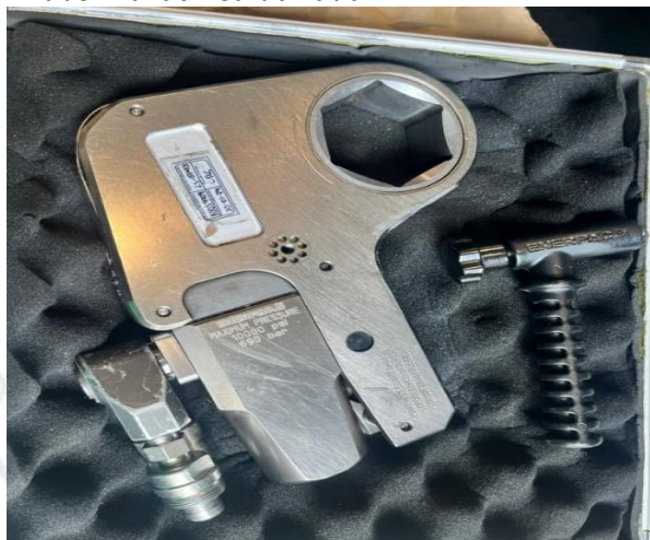
Figura 28 Llave hidráulica dañada
