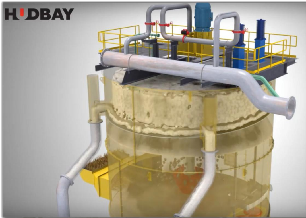
Figura 40 Distribución de la carga y reactivos en las celda Outotec-HBP.
