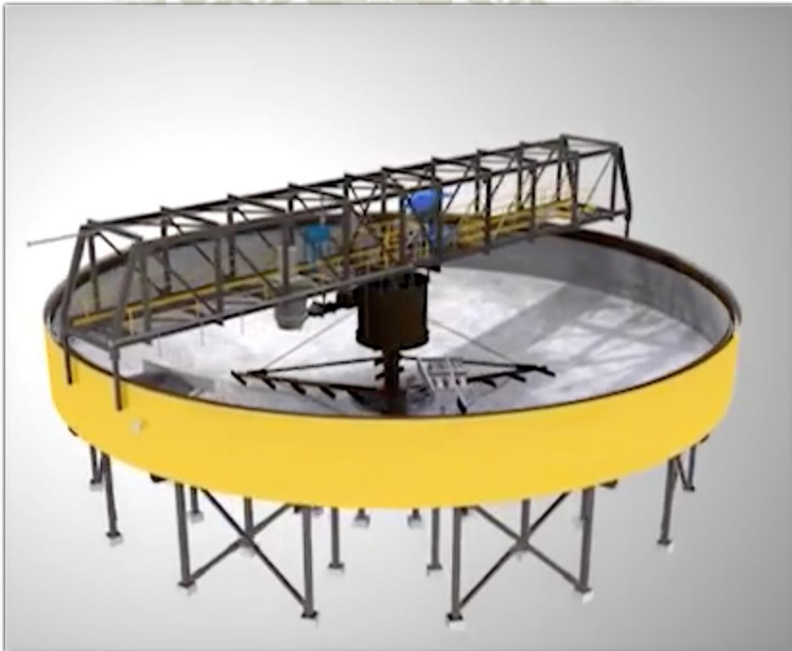
Figura 46 Principales partes del espesador de concentrado – esquema general
