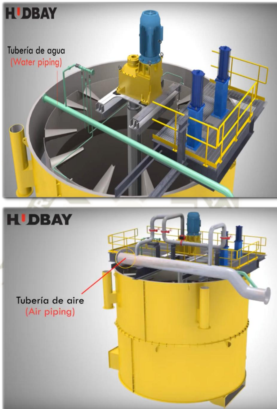
Figura 41 Partes principales de las celdas de flotación - Tuberías
