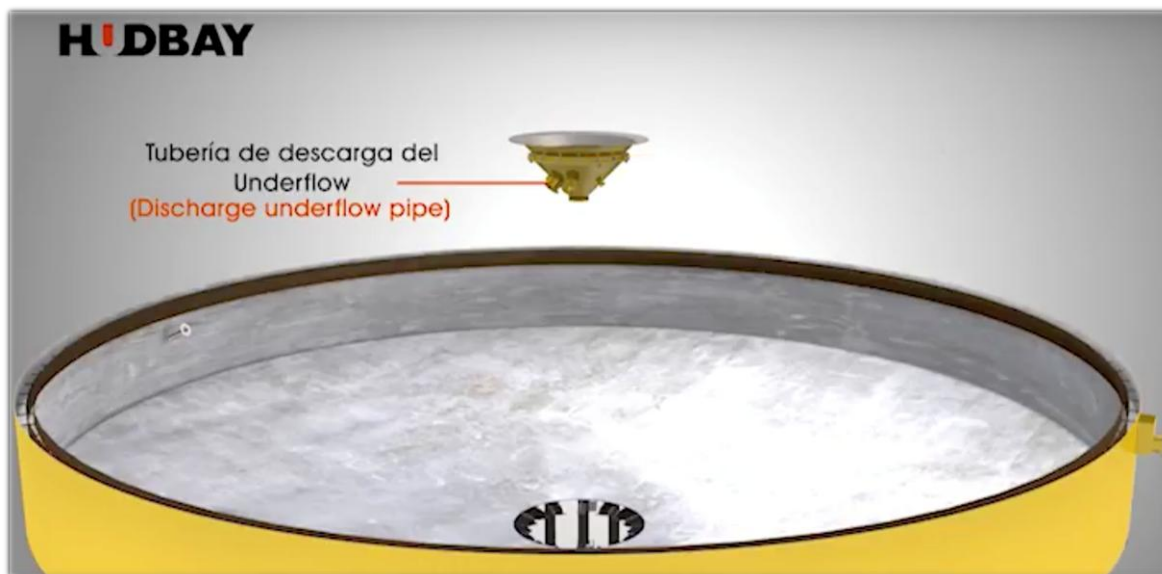
Figura 51 Principales partes del espesador de concentrado – tubería de descarga del Underflow.
