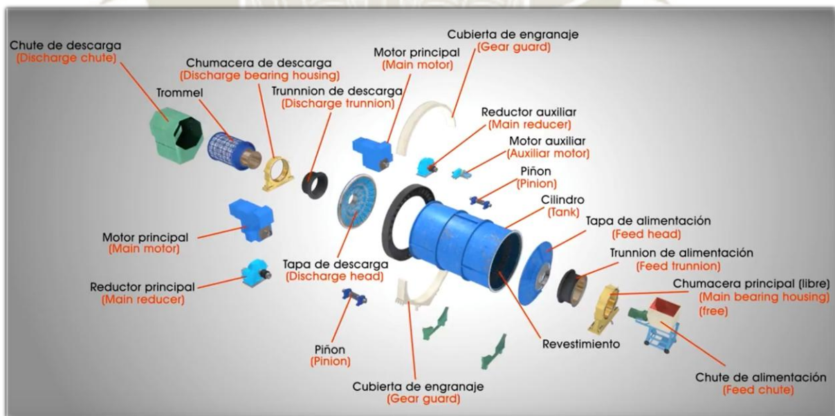
Figura 37 Esquema general de componentes principales del molino.
