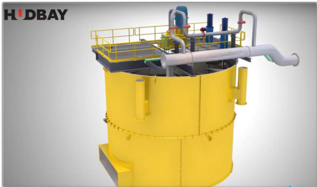
Figura 38 Esquema general de las celdas de flotación Outotec- HBP
