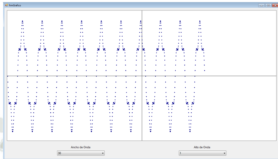
Figura 59: Gráfica del armónico de orden cinco sumado con la señal fundamental generado con los datos obtenidos anteriormente. Fuente: Elaboración propia
