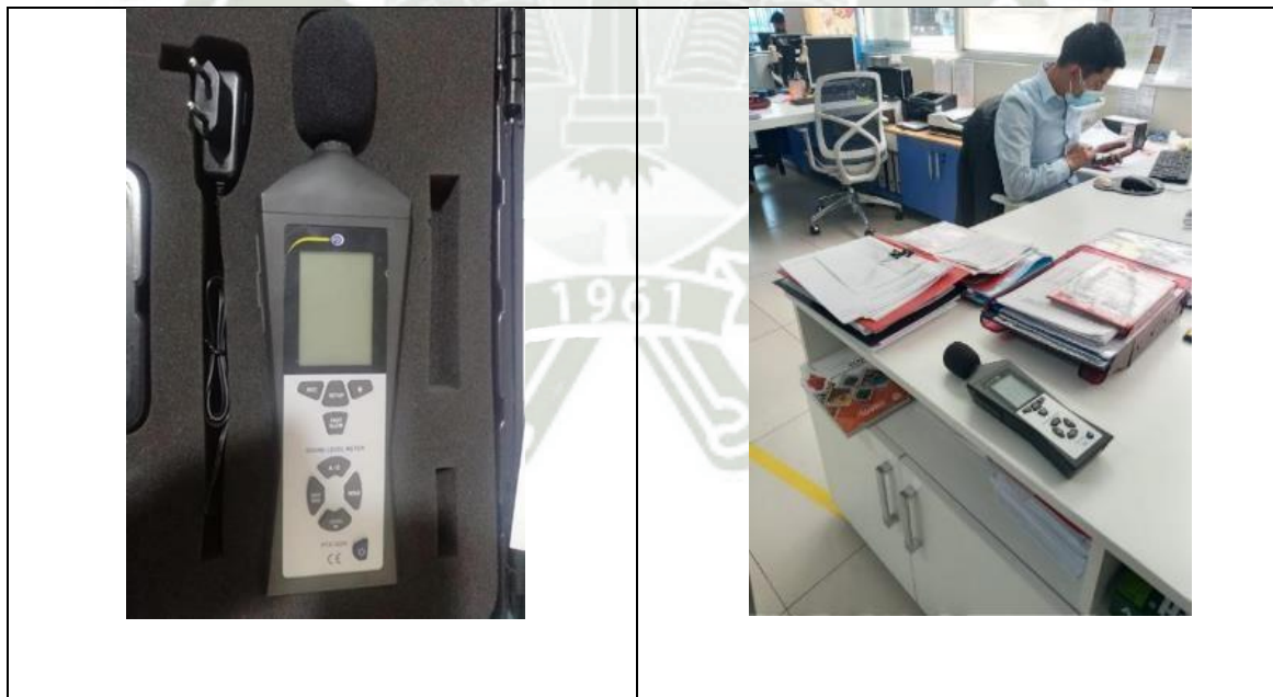
Figura 36: Toma de datos – Ruido en la EPS Área Administrativa
