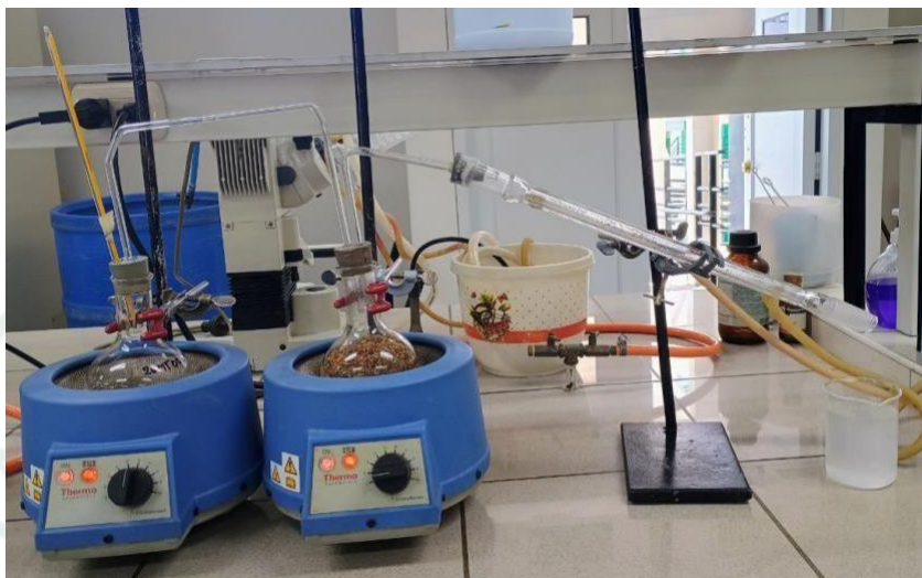
Figura 7 : Extracción mediante destilación por arrastre con vapor de agua del aceite esencial de hinojo
