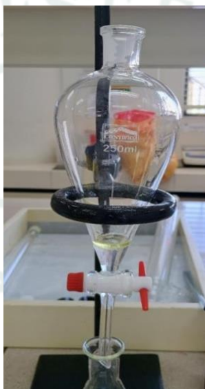
Figura 8 : Separación del aceite esencial de hinojo
