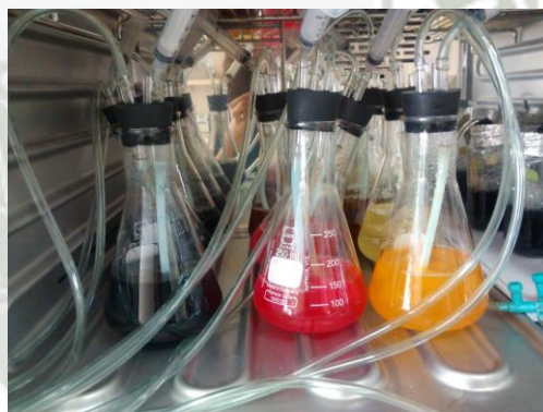
Figura N° 4.22.- Matraces con sistema de aireación a 35°C.
