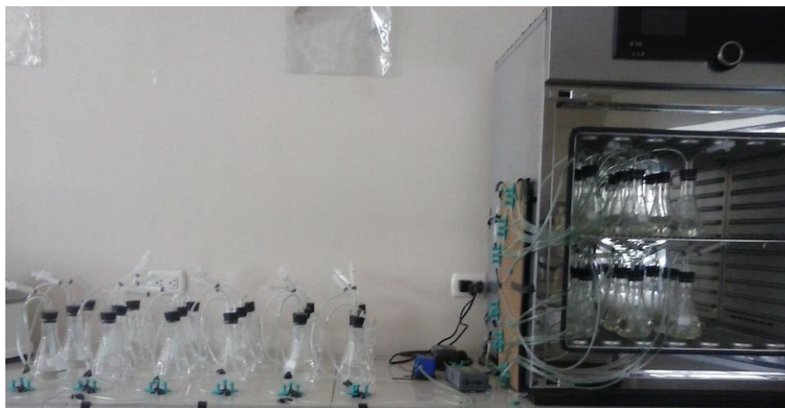
Figura N° 4.21.- Sistema de matraces para pruebas de decoloración (temperatura ambiente y a 35 °C (dentro de incubadora)).
