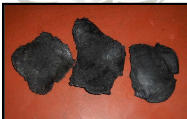
FIGURA N° 3.8 Mezcla Aplanado Caucho más PEAD
