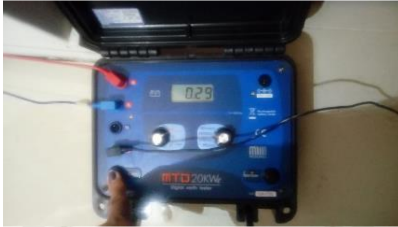
Fig. 4.17 .- Medición del pozo a tierra estructural del Laboratorio de Mediciones - Microscopio electrónico de barrido
