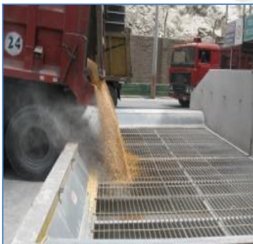
Descarga a zanja de silos
