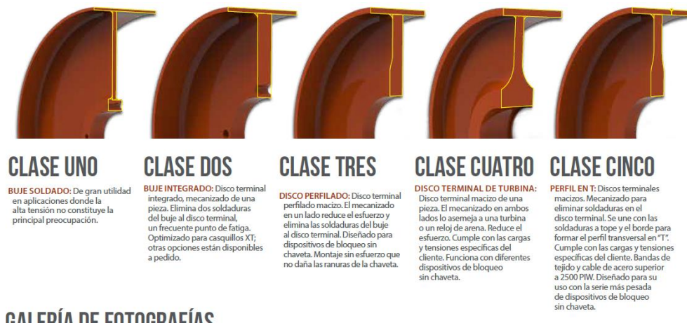
Figura 72 Tipos de discos terminales
