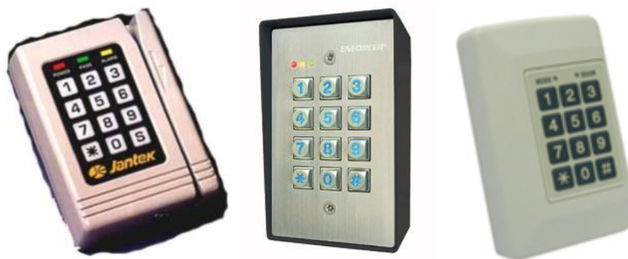
Fig. 30 Tipos de lectora de teclado
