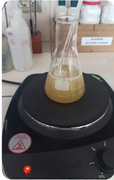
Fundición del agar en una estufa, moviendo constantemente hasta su primera ebullición y retirar.
