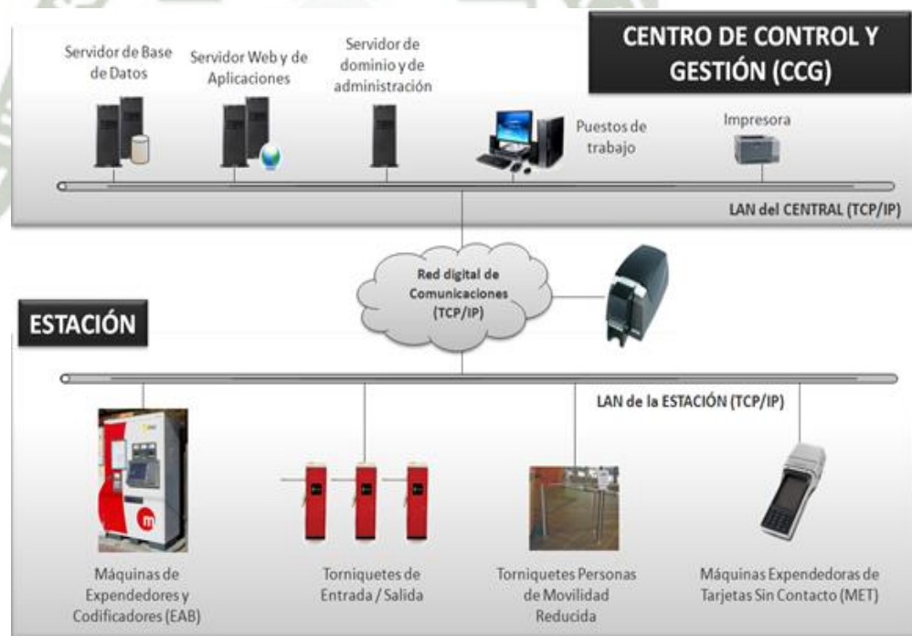
ILUSTRACIÓN II-5: Esquema de arquitectura y comunicaciones del SCP. 14
