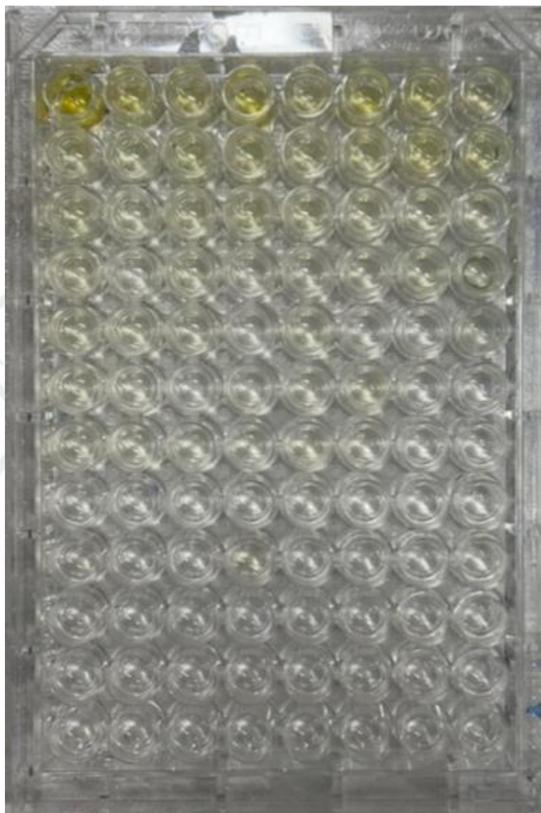
Foto 3: Aspecto final de la microplaca tras la solubilización con ácido acético glacial al 30%, previo a la lectura espectrofotométrica en el lector BIORAD PR-4100.
