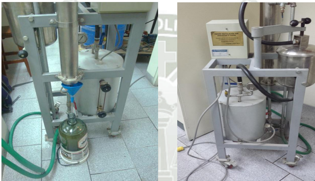
Figura 4.1 Equipo usado para la extracción de aceites esenciales
