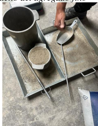
Figura 30 Ensayo de peso unitario suelto del agregado fino
