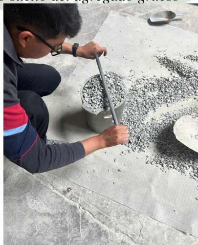
Figura 22 Ensayo de peso unitario suelto del agregado grueso
