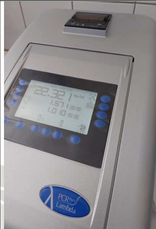
Evaluación de la cantidad y calidad de ADN por medio de espectrofotometría
