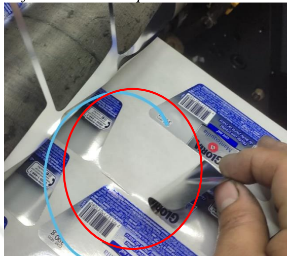
Figura 89 Defecto de sobretroquelado
