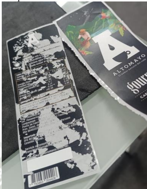
Figura 88 Desprendimiento de tinta
