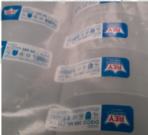
Figura 78 Adhesividad del sustrato débil (defecto)
