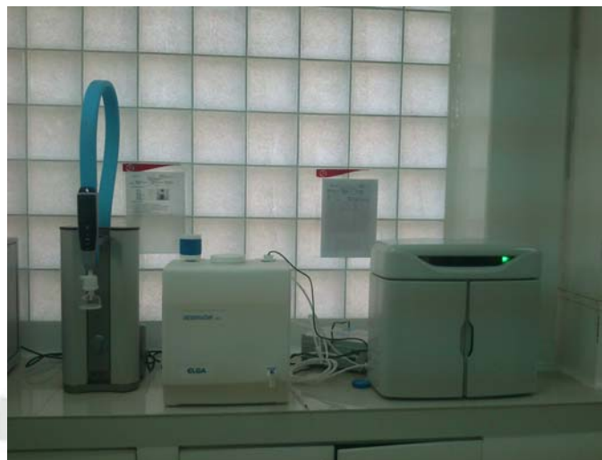
Anexo N° 127 Purificador de agua ELGA
