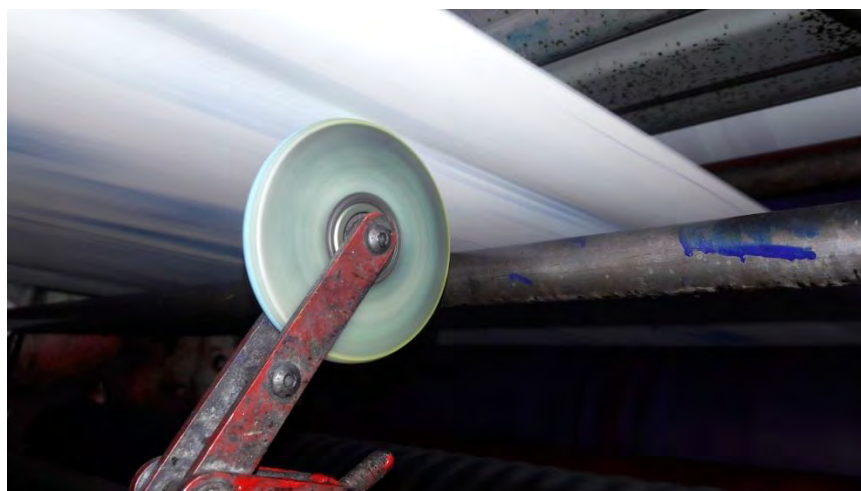
Imagen N° 12. Sensor de rotura de papel
