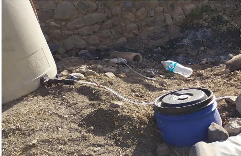
Figura 33. Tanque Imhoff a escala
