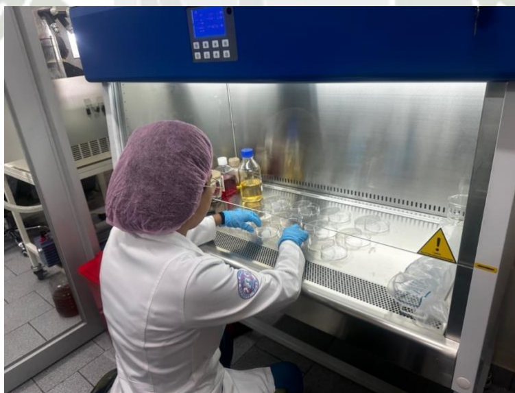
Elaboración de placas Petri estériles para la adición de agar Mueller – Hinton, dentro de la campana de bioseguridad.
