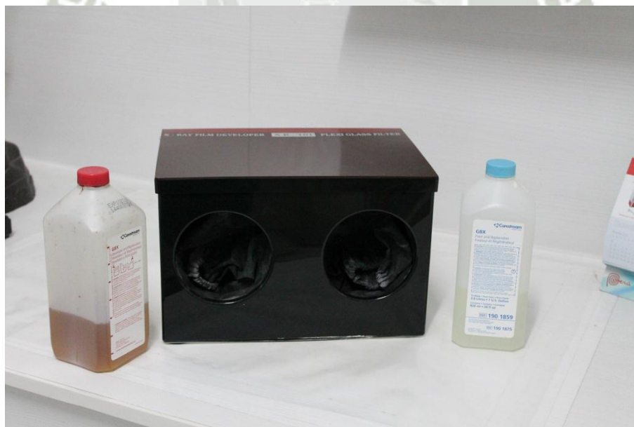
Fotografía N° 6. Caja de Revelado y Líquidos de Revelado
