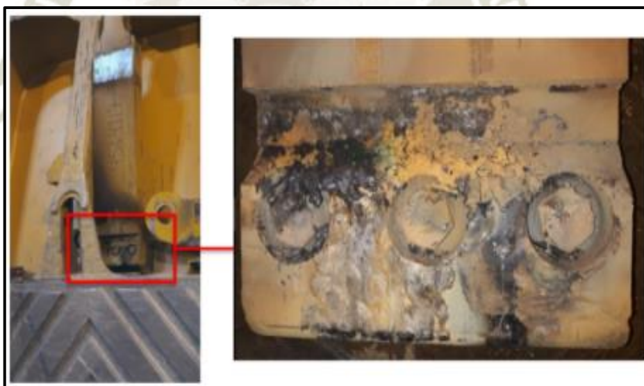
Figura 75 - Segunda fractura de inserto de barretón – Pala SH001
