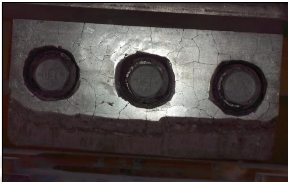
Figura 77 - Resquebrajamiento de inserto de barretón – Pala SH001
