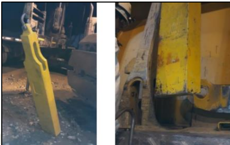
Figura 76 - Reemplazo de barretón sin inserto – Pala SH001
