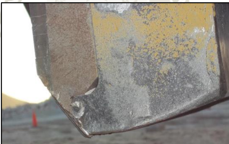
Figura 78 - Desgaste prematuro de inserto de barretón
